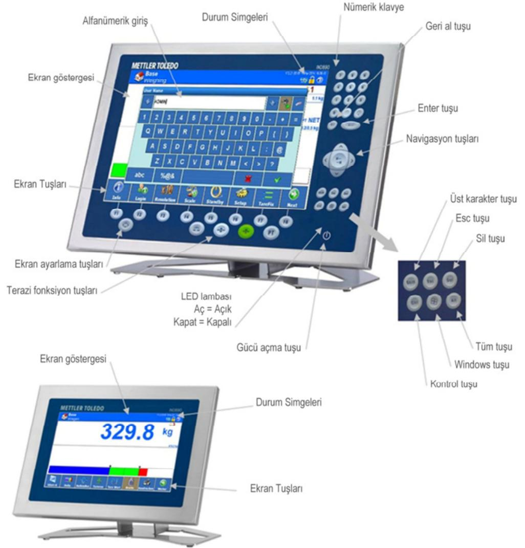
Ekranın alt kısmına sekiz adet ekran tuřu yerleřtirilmiřtir. Operatör, bu tuřları menüdeki kurulum seçenekleri arasında ve kurulum ile uygulama ekranları içinde gezinmek için kullanabilir.
