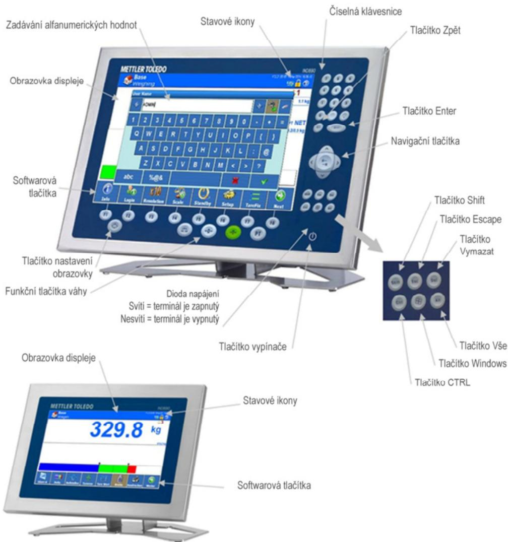
Pod displejem se nachází osm funkčních tlačítek. Tato tlačítka slouží k procházení možností nastavení v nabídce a na obrazovkách nastavení a aplikací.
